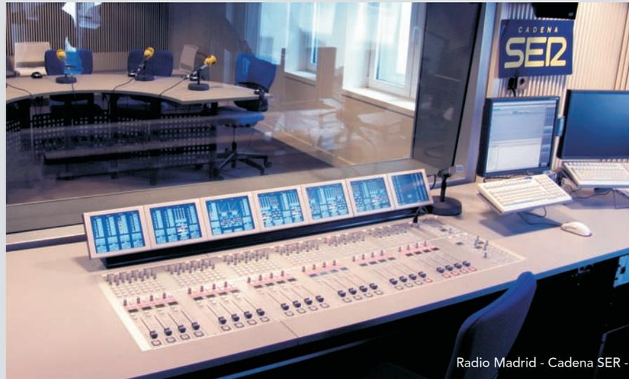
Todos los módulos de control están conectados a través de cables IT estándar usando Power over Ethernet (PoE). Esto le proporciona libertad para ubicar los módulos en la consola sin preocuparse por la longitud de los cables. De este modo, usted construye su consola conforme a su manera de trabajar y no al revés. Posee además pantallas TFT táctiles con un avanzado interface que le permitirá construir un sistema verdaderamente flexible.
