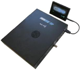
**Ikusnet BP** ha sido diseñado para facilitar su manejo y puede ser controlado desde un panel táctil independiente conectado al equipo mediante cable USB, o desde un interfaz web. El panel táctil permite monitorizar y controlar el sistema mientras se lleva a la espalda. Además, un canal de audio bidireccional IFB/Talkback permite al reportero hablar con el estudio y viceversa.
